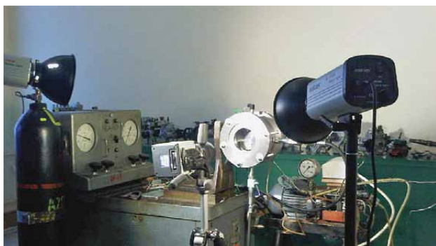
1 pav. Degalų įpurškimo tyrimų stendas
